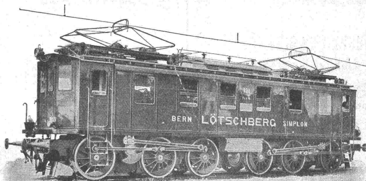
2000 PS Einphasenlokomotive der Lötschbergbahn.
