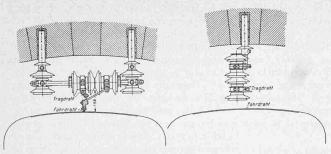
Abb. 3. Haupt- und Zwischenstützpunkt der Tunnelaufhängung. Masstab 1:25.
