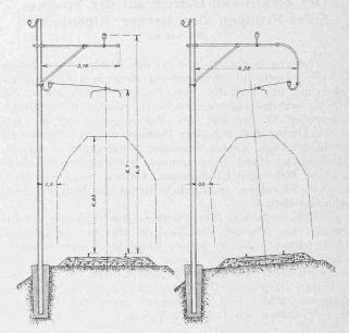
Abb. 4. Tragmaste auf freier Strecke. - Masstab 1:150.
