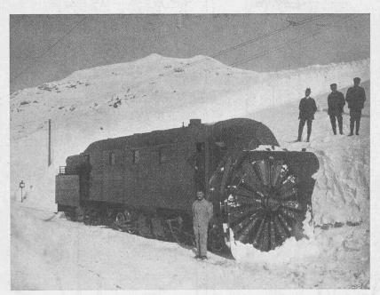
Abb 3. Schneeschleudermaschine von vorn.
