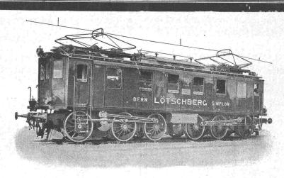
2000 PS Einphasenlokomotive der Lötschbergbahn.
