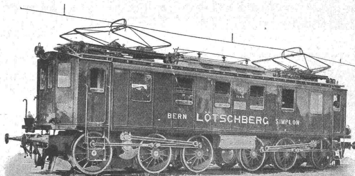
2000 PS Einphasenlokomotive der Lötschbergbahn.
