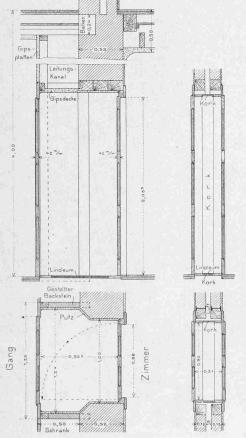
Abb. 4. Schalldichte Konstruktion der Doppeltüren. — 1:40.
