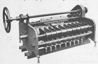
Abb. 8. Kontroller mit abgehobenen Gehäusehälften.
