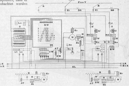
Abb. 6. Schaltungsschema der 250 PS Valle-Maggia-Lokomotive.
