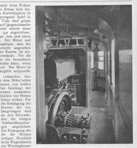
Abb. 3. Blick auf den eingebauten Motor mit darüber liegendem Kontroller, dahinter der Transformator.
