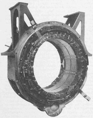
Abb. 9. Stator des Motors mit Kontroller-Konsolen.
