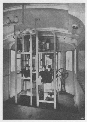
Abb. 7. Hochspannungskasten der Lokomotive (Verschalung weggenommen) mit Sicherungsapparaten und Oelschaltern.
