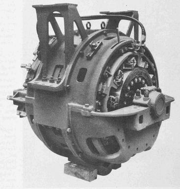
Abb. 10. 250 PS Einphasen-Wechselstrom-Bahnmotor.
