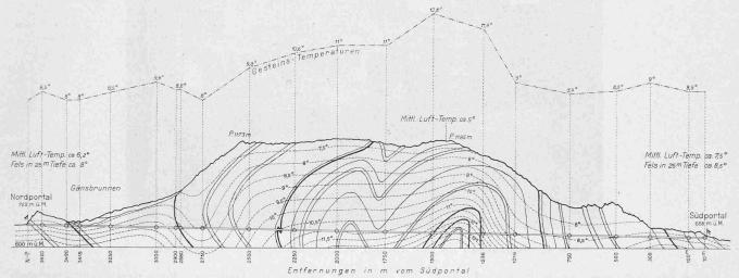
Abb. 34. Im Tunnel beobachtete Gesteinstemperaturen und daraus abgeleitete Geoisothermen des Weissensteinmassivs. — Masstab I: 20000.
