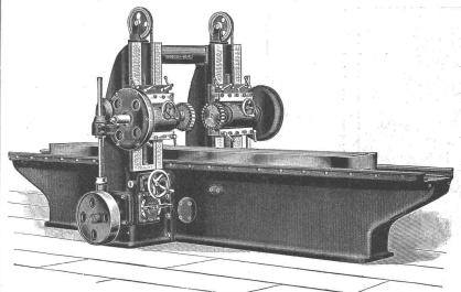
Doppel-Plan-Rapid-Fräsmaschine mit Einzelscheiben-Antrieb.
