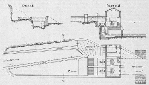
Abb. 40. Turbinenanlage mit Grundwehr zur Verhinderung der Ausnützung des Kanalinhaltes. - 1:600.
