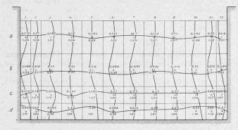
Abb. 41. Geschwindigkeitsdiagramm bei besonders unruhigem Wasser.
