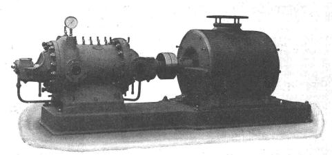
Sulzer-Hochdruck-Zentrifugalpumpe direkt gekuppelt mit Elektromotor.
