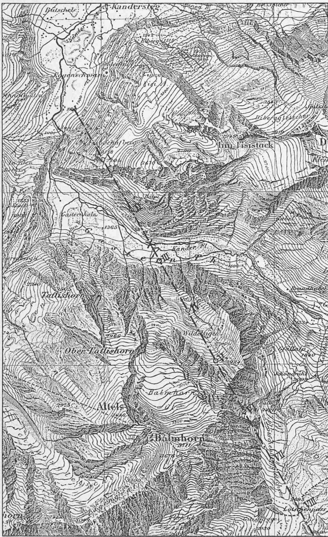
Mit Bewilligung der eidg. Landestopographie. Abb. 3. Uebersichtskarte des Gasterntals mit der ursprünglichen Axe des Lötschberg-Tunnels. — 1 : 60 000. (Das X bezeichnet die Einbruchsstelle bei Km. 2,675.)
