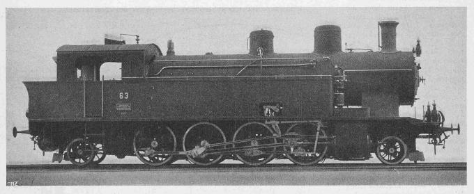
Abb. I. Heissdampf-Tenderlokomotive Ec4/6 gebaut von der Schweiz. Lokomotiv- und Maschinenfabrik Winterthur.
