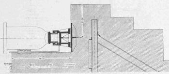
Abb. 16. Längsbewegliche Abstützung der Rohr-Endekrümmer. — 1:50.
