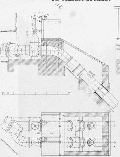
Abb 9. Rohrgabelung, Schieberhaus und Expansion am obern Leitungsende. — 1:100.
