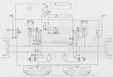
Abb. 17. Schema der Druckluftleitungen eines Motorwagens.
