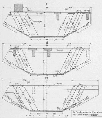
Abb. 3. Armierung der Querträger V bis VII. — Masstab 1:150.
