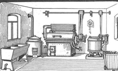
Muldenmangel mit Absaugevorrichtung für Dampf- z Gasheizung
