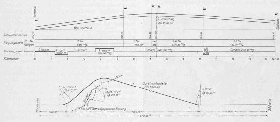
Abb. 3. Richtungs- und Höhenverhältnisse des Lötschbergtunnels von Kandersteg nach Goppenstein. - Längenmasstab 1:100 000.
