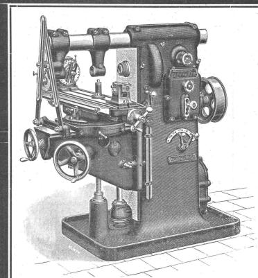
Wanderer-Rapid-Fräsmaschine Nr. 2 mit Einzelscheiben-Antrieb.
