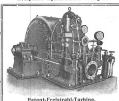
Patent-Freistrahl-Turbine, 2500 HP, 300 Meter.
