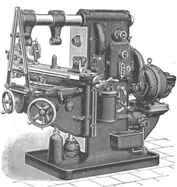
Wanderer-Rapid-Fräsmaschine Nr. 2 mit Elektromotor-Antrieb.
