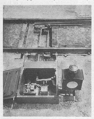
Abb. 8. Elektropneumatische Weichenantriebvorrichtung.
