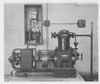
Abb. 1. Verbundkompressor mit selbsttätigem Anlasser (an der Wand).
