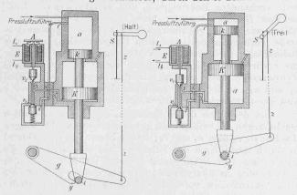
Abb. 2 und 3. Vorrichtung mit zwangsweiser Rückstellung.
