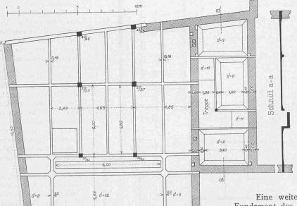
Abb. 1. Grundriss des I. Stocks von Magazin I (u. Treppenhaus) mit Aufzugöffnung und Transportschlitz I. - Masstab 1:200.
