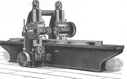
Doppel-Plan-Rapid-Fräsmaschine mit Einzelscheiben-Antrieb.
