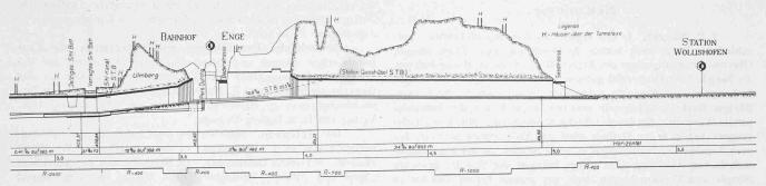
Abb. 4. Längenprofil Wiedikon-Enge-Wollishofen. — Masstab 1:15000 für die Längen, 1:1500 für die Höhen.1)
