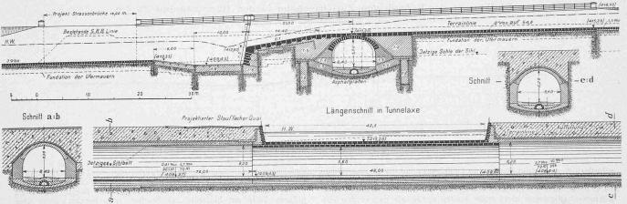
Abb. 5. Querschnitt und Längsschnitt der Sihlunterfahrung. - Masstab 1:600.
