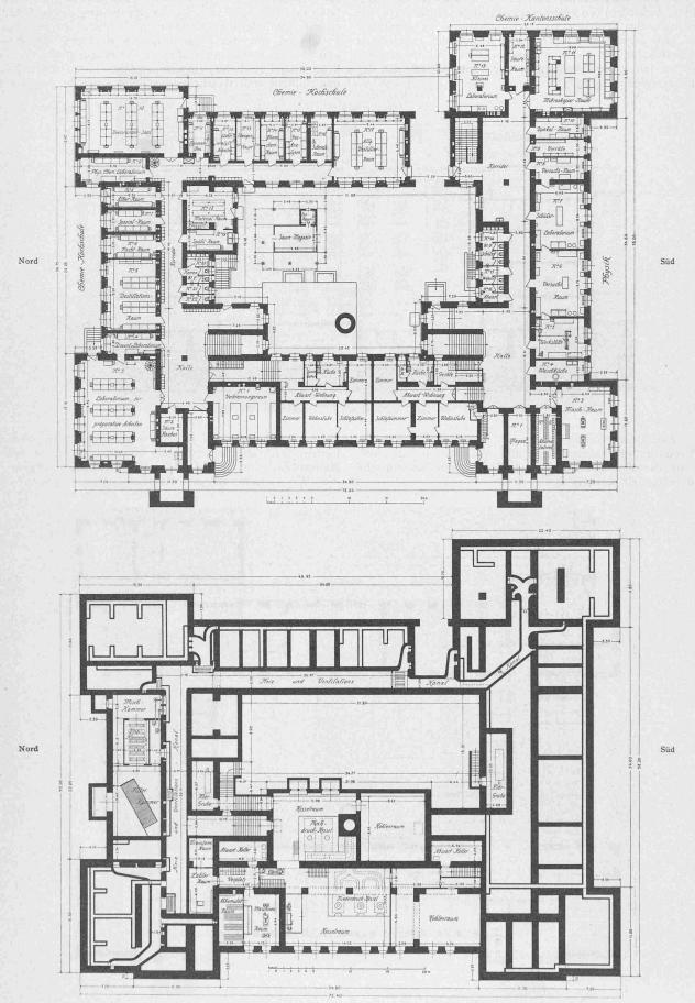
Abb. 3 und 4. Grundrisse vom Heizgeschoss und vom Untergeschoss. - Masstab 1:500.
