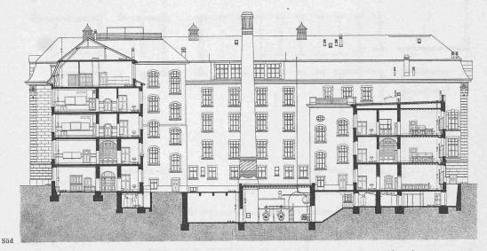
Abb. 9. Querschnitt durch Süd- und Nordflügel mit Rückansicht des Westflügels. — Masstab 1:500.
