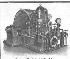
Patent-Freistrahl-Turbine, 2500 HP, 300 Meter.
