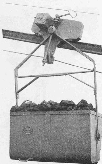
Abb. 6. Elektroseilbahnwagen auf der Steigung.
