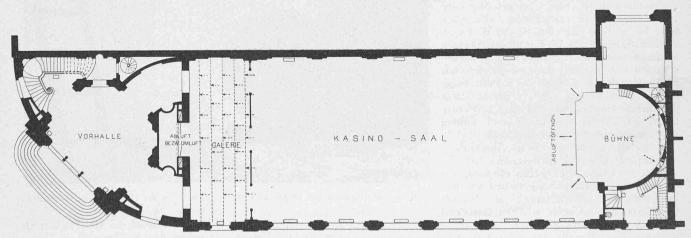
Abb. 35. Erdgeschoss-Grundriss des grossen Saales im «Casino du Rivage» in Vevey. — Masstab 1:300.
