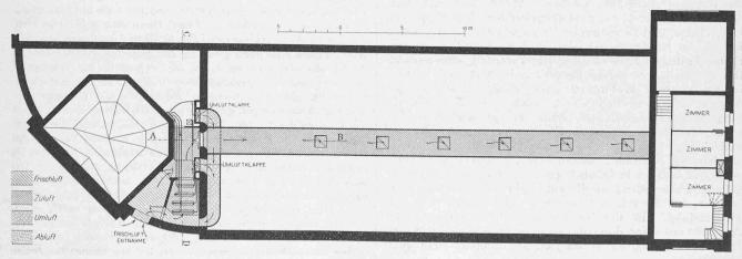
Abb. 36. Heizkammer und Zuluftkanal im Dachraum des «Casino du Rivage». — Masstab 1:300.
