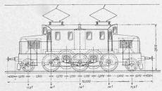
Abb. 8. Personenzugslokomotive für die Wiesenthalbahn, gebaut 1910 von Brown, Boveri & Co. mit der Karlsruher Maschinenbau-A.-G.
