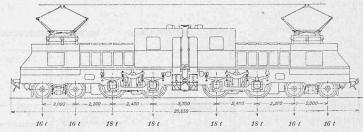
Abb. 12. Schnellzugslokomotive für die Paris-Lyon-Mittelmeer-Bahn von der E.-G. Alioth, Münchenstein.
