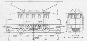
Lokomotive der Simplonbahn, gebaut 1906 Abb. 4.
