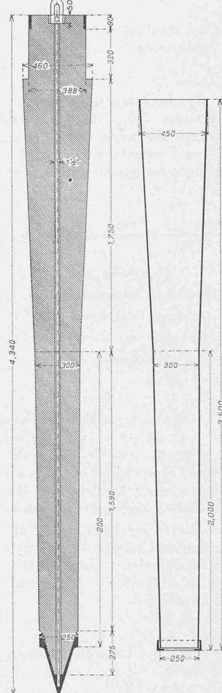
Abb. 1. Rammkern und Blechrohr
