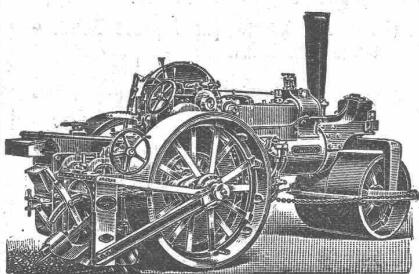
lieft kaufs- und mietweise **DAMPFSTRASSENWALZEN**, Patent Aveling & Porter, mit oder ohne mechanischem Strassenauflöser; in Gebrauch bei einer grossen Anzahl schweiz. Behörden. Strassenlokomotiven zur Beförderung leichter und schwerer Lasten.
