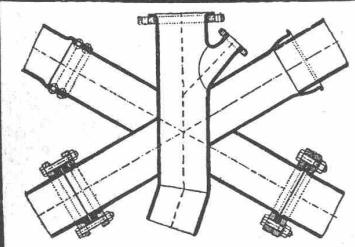
Schmiedeeisen- oder Stahl-Muffenrohre liefern wir, ebenso wie alle andern Rohre, bis zu 16" Durchmesser durch das Walzverfahren hergestellt, und zwar die kleineren Durchmesser nahtlos, die größeren Durchmesser überlappt geschweißt, dagegen über 16" bis zu den größten Durchmessern mittels Wasser-gas maschinell geschweißt.
