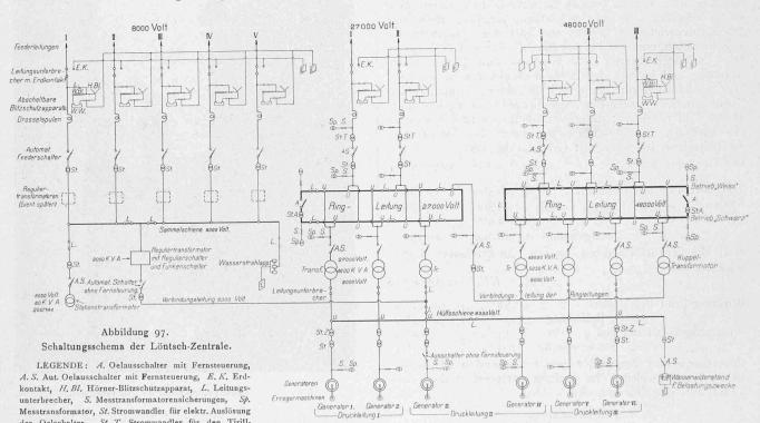
der Oelschalter, St. T. Stromwandler für den Tirillapparat, St. Z. Stromwandler für die Zähler und Wattmeter, Tr. Dreiphasen-Transformator, U. Stossunterbrecher, W. Bl. Wurzblitzschutzapparat, WW. Wasserwiderstand für
