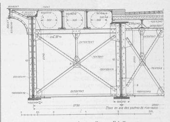
Fig. 9. Coupe transversale sur piles. — Echelle 1:50.
