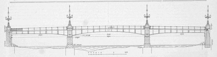
Fig. 3. Elevation du nouveau pont des Acacias. — Echelle 1:400.
