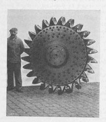
links abgebildete Hochdruckrad, das mit einem äussern Durchmesser von rund 2 m und einem Gewicht von 1000 kg bestimmt ist, bei Gefälle von 800 m und einem Wasserkonsum von 350 I/sek mit 630 Uml/min eine Kraftleistung von 3000 PS abzugeben. Dieses Rad ist für die neue Kraftzentrale "Arniberg" des Elektrizitätswerkes Rathausen bestimmt.
