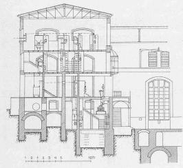
Abb. 8. Schnitt durch Schaltbühne und Apparatenhaus. Masstab I: 400.
