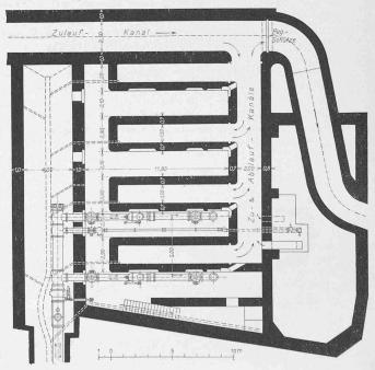
wird, hat eine Gesamtlänge von 2165 m; sie verläuft in Abb. 4. Horizontalschnitt durch Wasserkammern u. Rohrkanäle. — 1:300.
