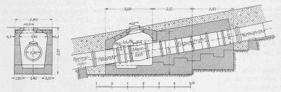
Abb. 12. Fixpunkt II mit Einsteigeschacht. - Masstab 1:150.
