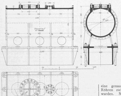
Abb. 9. Stahlguss-Verankerungsstück für Fixpunkt VII. — 1:30.
