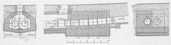
Abb. 11. Stollenende und Fixpunkte V, Beginn der Grabenstrecke. Quer- und Längsschnitte. — Masstab 1:150.
