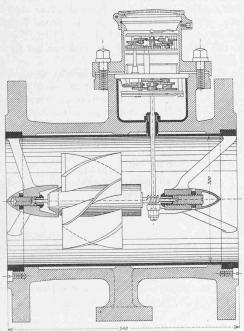
Abb. 4. Schnitt durch den Wassermesser. - Masstab 1:8.
