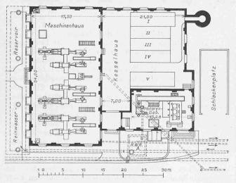
Abb. 1. Grundriss der Pumpen-Anlage im Riet bei Rorschach. — 1:600.
