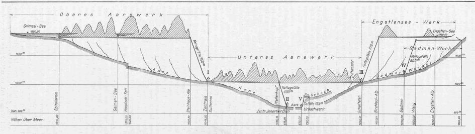
Abb. 2. Generelles Längenprofil der Oberhaslewerke. — Masstab für die Längen 1:150000, für die Höhen 1:30000.
