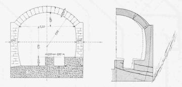
Abb. 19 und 20. Profil des Stollens II mit vollkommener Mauerwerkverkleidung und Verschiebung (karikiert) der Widerlager, Zerstörung des Kanals und des Gewölbes durch Verschiebung des Widerlagerfusses auf den Rissen im Beton. Masstab 1:100.
