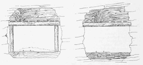
Abb. 13 und 14. Stauchung der Schieferschichten in First und Sohle des Stollens II von Km. 6,710 bis Km. 6,860.
