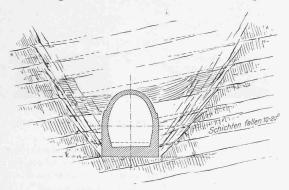
Abb. 18. Lockerung des Gesteins bis zur Abbruchfläche hinter den Ausbruchöffnungen.
