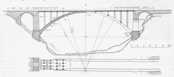
Längenschnitt (links durch einen Bogen, rechts durch die Brückenachse) und Grundriss. — Masstab 1:750.
