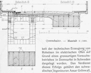
Axel Lindblad und Otto Stalhane, denen es gelungen ist, einen für die Praxis brauchbaren elektrischen Hochofen auszubilden. Derselbe ist als Schachtofen mit erheblicher Querschnittserweiterung in der untersten Zone, die als eigentlicher Schmelzraum zu betrachten ist, ausgeführt. In diesen Schmelzraum ragen von oben und aussen her die rings von der Beschickung umgebenen Elektroden hinein, die, in der Zahl von drei Stückstür einen Ofen, mit Drehstrom von 25 Perio-
