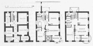
Abb. 3. Grundrisse vom Kellergeschoss, Erdgeschoss und Obergeschoss. Masstah I: 400.
