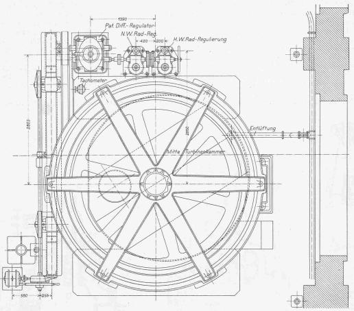
Abb. 11. Draufsicht auf den von der Masshinenfabrik Oerlikon gebauten Generator. - Masstab 1:50.
