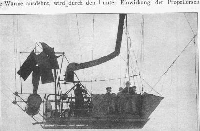
Abb. 7. Gondel des Parseval-Luftschiffes; Luftschraube in Ruhestellung. Nach einer Teleobjektiv-Aufnahme von Herrn Aug. Vautier-Dufour in Grandson.
