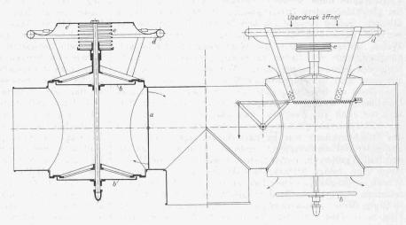
Abb. 6. Schnitt und Ansicht des Parsevalschen Luftventils. - Masstab 1:10.
