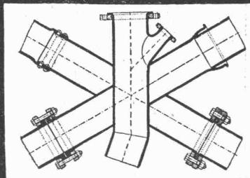
Schmiedeeisen- oder Stahl-Muffenrohre liefern wir, ebenso wie alle andern Rohre, bis zu 16" Durchmesser durch das Walzverfahren hergestellt, und zwar die kleinern Durchmesser nahtlos, die gröbneren Durchmesser überlappt geschweißt, dagegen über 16" bis zu den gröbtesten Durchmessern mittelst Wasser-gas maschinell geschweißt.
