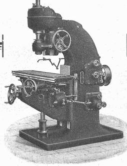
Einfache, Universal-, Plan- und Vertikal-Fräsmaschinen.
