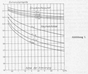
punktes bei steigendem Armierungsprozent durch Kurven dargestellt; daraus lässt sich der Abstand von Zug- und Druckmittelpunkt bei bekannter Armierungsstärke ablesen.
