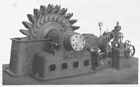
Abb. 21. Peltonturbine für 5500 PS mit Handregulierung der Düsennadel. Gebaut von Piccard, Pictet & Cie. in Genf.
