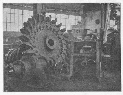
Abb. 24. Rad, Nadeldüse und Strahlablenker der 5500 PS-Turbine.
