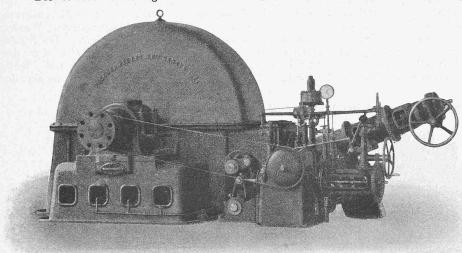
Abb. 27. Ansicht der Turbine mit kombinierter automatischer Nadel- und Ablenker-Regulierung.
