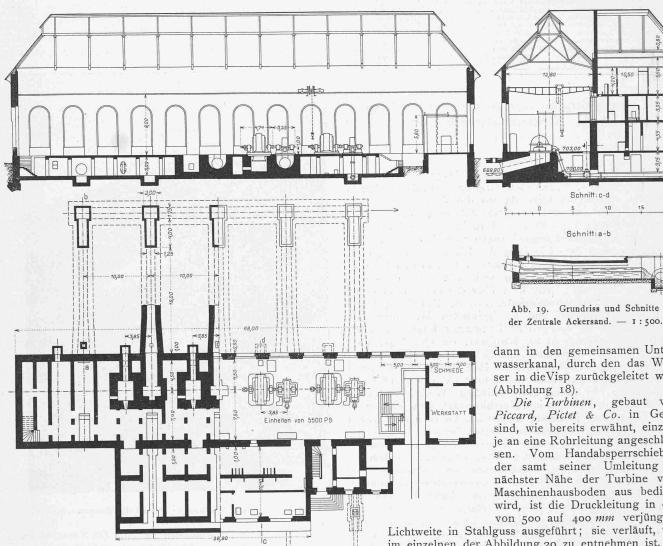
Strahlablenker beeinflusst, der den Wasserstrahl teilweise oder ganz in den Unterwasserkanal ablenkt. Jede Turbine besitzt einen eigenen, mit Eisenblech ausgelegten Unterwasserkanal von halbkreisförmigem Querschnitt (Abb. 20), der das Abwasser mit starkem Gefäll in einen ausserhalb des Gebäudes liegenden Kanal mit Messüberfall abführt. Die fünf Messkanäle (vergl. auch Abbildung 19) münden dann in den gemeinsamen Unterwasserkanal, durch den das Wasser in dieVisp zurückgeleitet wird
