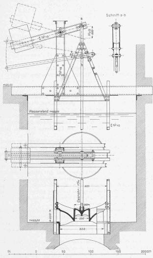
Abb. 12. Automatisch schliessendes Einlaufventil. — 1:30.
