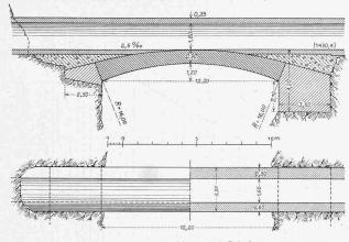
Abb. 10. Kanalbrücke, Draufsicht und Schnitte. - 1:250.
