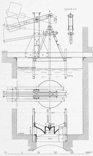
Abb. 12. Automatisch schliessendes Einlaufventil. — 1:30.
