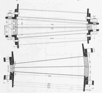
Abb. 16. Keilringe der genieteten und der geschweissten Rohre,
