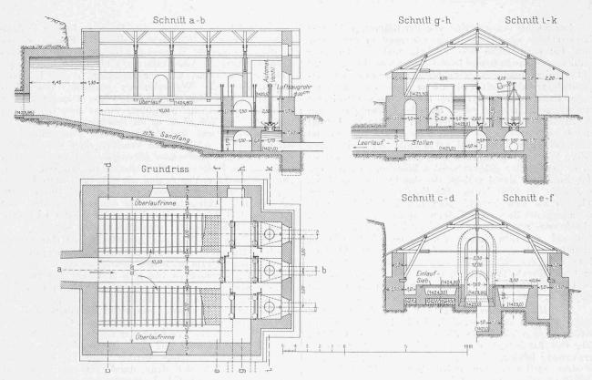
Abb. 11. Das Wasserschloss; Horizontal-, Längs- und Querschnitte. — Masstab 1:250.
