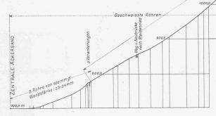
Abb. 13 Lageplan und Abb. 14 Längenprofil der Druckleitung der Wasserkraftanlage Ackersand.
