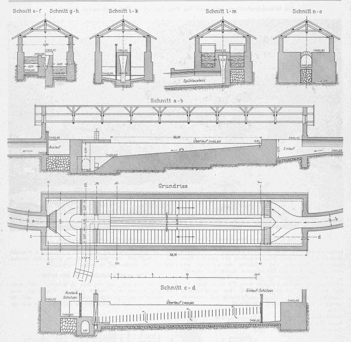
Abb. 7. Horizontal-, Längs- und Querschnitte der Kläranlage. — Masstab 1:250.
