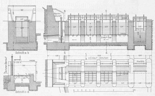
Abb. 5. Grundriss und Schnitte des Kanal-Stauwehrs. — Masstab 1:250.
