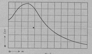
Bodenbeleuchtungskurve einer Wechselstrom-Flammenbogenlampe mit TB-Kohlen.
