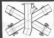
Schmiedeeisen-oder Stahl-Muffenrohre liefern wir, ebenso wie alle andern Rohre, bis zu 16" Durchmesser durch das Walzversahren hergestellt, und zwar die kleinern Durchmesser nahtlos, die größern Durchmesser überlappt geschweist, dagegen über 16" bis zu den größten Durchmessern mittelst Wassergas maschinell geschweist.
