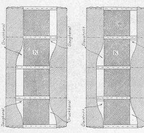
Abwicklung zu Abbildung 1. - Masstab 1:5. Abb. 4 für Motorwirkung. Abb. 3 für Pumpenwirkung.
