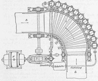
Abb. 5. Gepäckförderanlage im Hamburger Hauptbahnhof, Richtungsänderung der Förderrinne. — Masstab 1:100.1)
