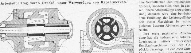
Abb. 1. Längs- und Querschnitt der Pittlerschen Rundlausmaschine. — 1:5.
